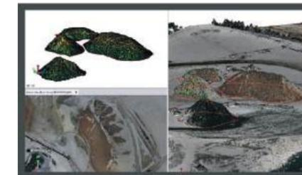
Calcolo preciso delle superfici e delle quantità di scorte volumetriche
