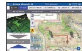
**Siteworks SE Starter Edition** è una versione semplificata del software, pensata per chi non necessita di tutte le funzionalità e cerca una soluzione economica per la connessione esclusiva al GNSS. Come la versione standard, include reporting in formato PDF, compensazione dell'inclinazione e misurazioni in modalità veicolo. Grazie alla sua massima compatibilità, permette un facile aggiornamento alla versione completa di Siteworks, adattandosi alle crescenti esigenze lavorative.
